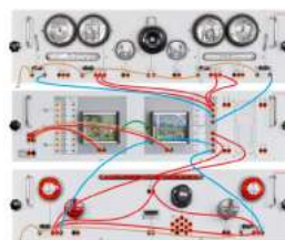
Ansteuerung der Hauptbeleuchtung über eine einzelne Bus-Leitung
