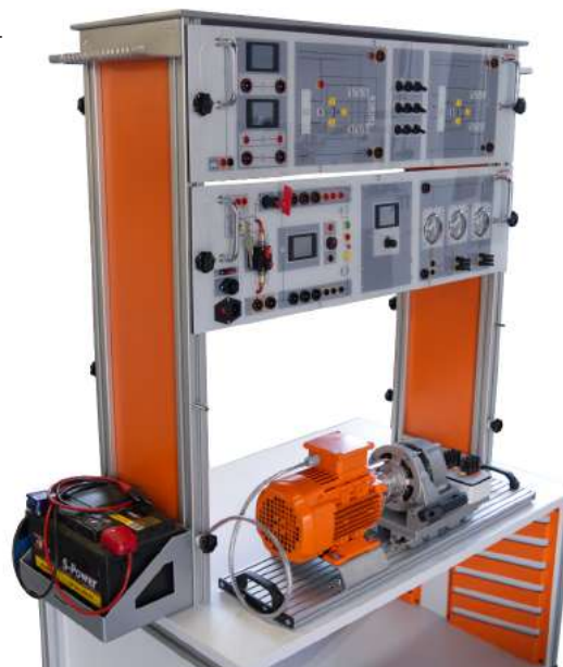
Abb.: T-Varia Wagen mit Batteriehalter, T-Varia Grundausstattung Generator, Generator mit Transistorregler sowie T-Varia Gleichrichtung Generator
